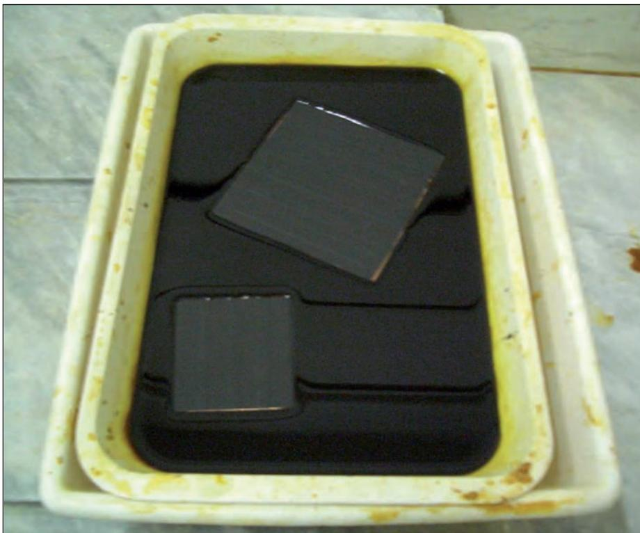
Figura 9: circuiti immersi nel percloruro ferrico.
