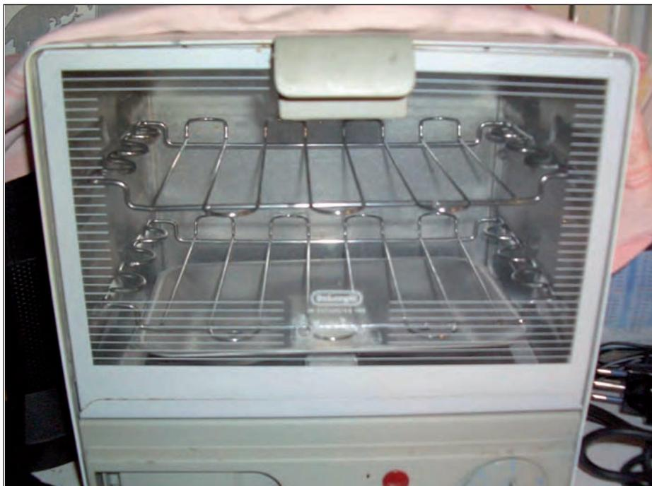
Figura 5: un semplice fornello a grill dove scaldare la basetta per qualche minuto.
